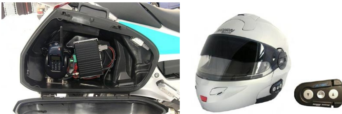
Obr. 35. Umístění terminálu v motocyklu a bluetooth modul v ochranné helmě [25]
