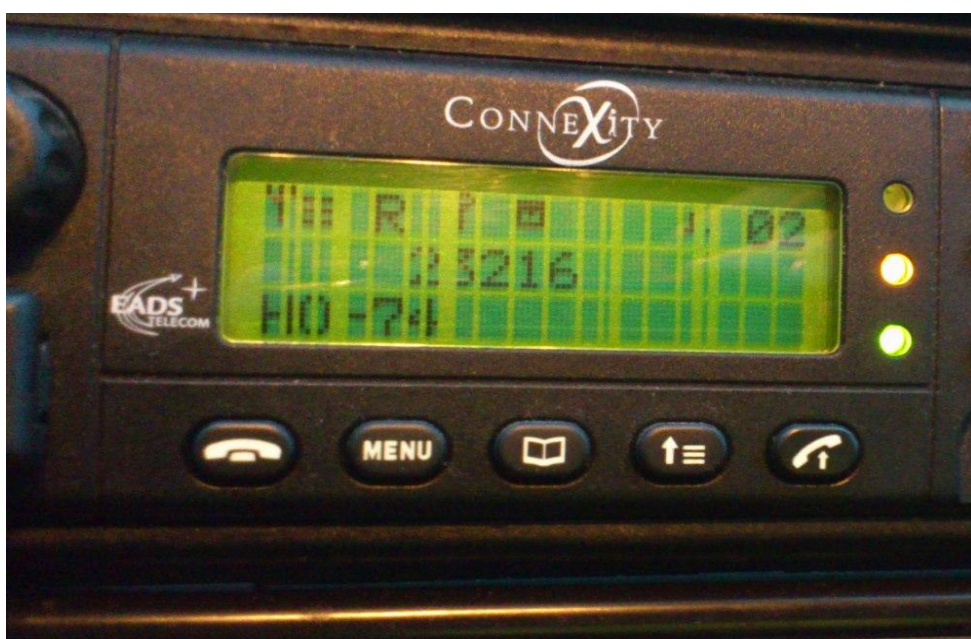
Obr. 32. Vozidlový terminál - porucha displeje
