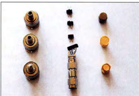
Bild 5: BNC-, Stecksocket- und SMA-SOL-Standards (v.l. n. r.) als Kalibrierelemente
